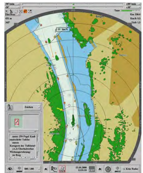
Inland ECDIS im Navigationsmodus mit überlagertem Radarbild
