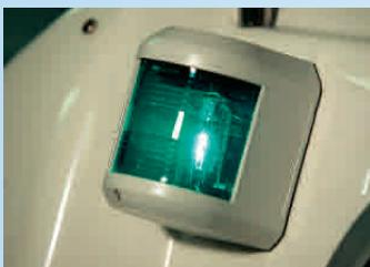
Das Toplicht (225°) muss bei Booten ab 12 m, aber kleiner 20 m mindestens 2,50 m über dem Schanndeckel und 1 m über den Seitenlichtern sitzen. Bis 12 m reicht es, wenn sie 1 m über den Seitenlichtern montiert sind. Das Hecklicht (135°) muss so nah wie möglich am Heck sitzen. Als Seitenlichter darf man grüne und rote Einzellaternen oder die Zweifarbenlaterne führen (1 und 2). Boote unter 12 m Länge darf man anstatt mit einzel-
